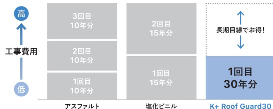
一般的な塩ビシートでは10年に1回の工事に加え、30年目以降は既存防水層の撤去費用も発生します。K+ Roof Guard30は30年目以降は部分補修で済むため、優れたコストパフォーマンス。
